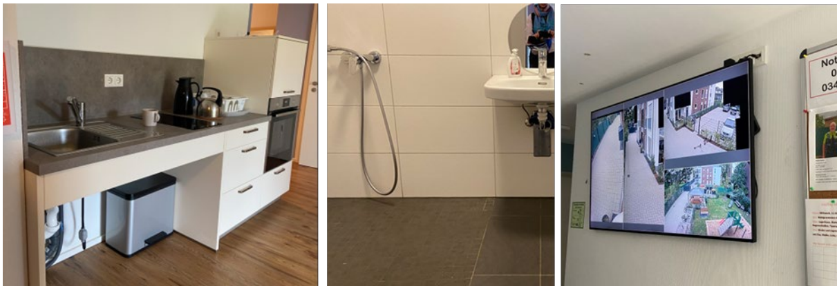
Küche mit unterfahrbarer Spüle, barrierefreies Bad, Überwachungsbildschirm im Erdgeschoss. Quelle: IfS
