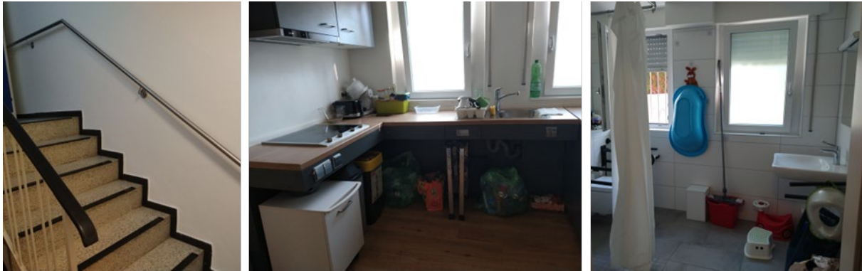
Neu montierter Handlauf im Treppenhaus, höhenverstellbare Arbeitsfläche in der (Gemeinschafts-)küche, barrierefreies Badezimmer. Quelle: IfS
